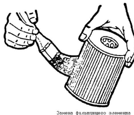
Замена фильтрующего элемента
